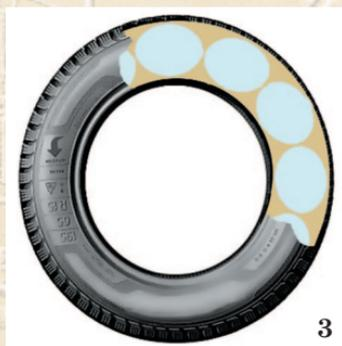
Шина все совершенствуется: 1 — с камерой и покрывшкой, 2 — бескамерная, 3 — конструкция с капсулами и губчатой резиной.
